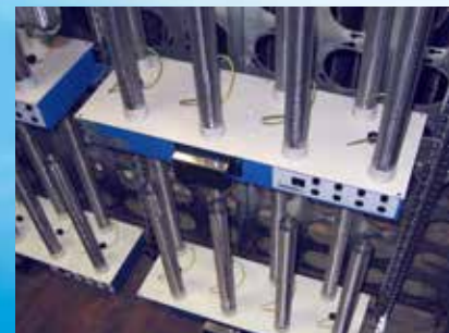
| Assemblage dans une section de filtrage à charbon actif modifiée
